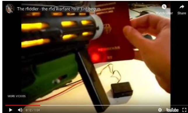
Figuur 2. Paspoort waarvan de chip vernield wordt met een elektromagnetische puls..
