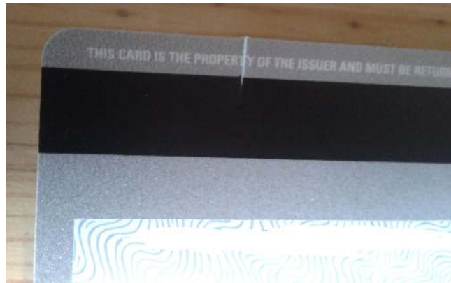
Figuur 4. Kaart met een inkeping ter hoogte van de antenne. (Bron: https://linuxcentre.net/disabling-contactless-cards )
