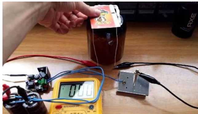
Figuur 3. Opstelling (met zichtbare componenten) voor het vernietigen van contactloze chips.
