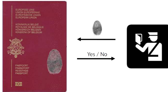
Figuur 6. Illustratie van de werkwijze van een match-on-card systeem.
